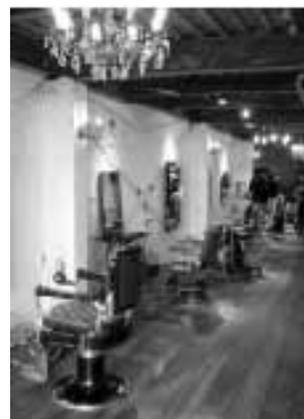
内装仕上：床イギリスの古材フローリング使用釘跡のあるもの表面を適度に研磨しイギリスのワトコオイルを塗布した。
